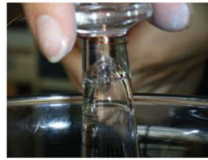
1. 水上置換で空気を集める
