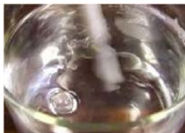
溶液を揺らすとアンチドームは崩壊しない
